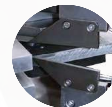
Cuchillas de limpieza superior e inferior
