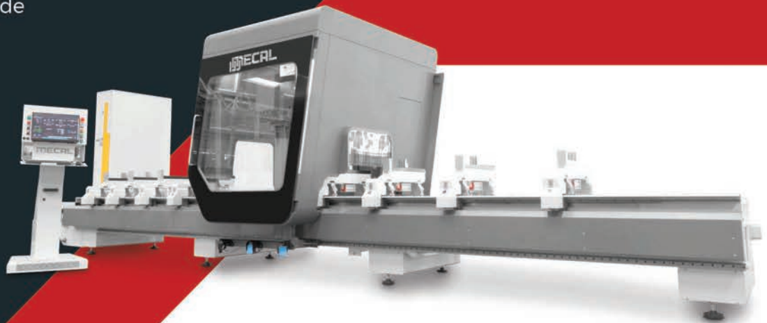
MC 304 Ariel-5 Centro de maquinado CNC de 5 ejes.
