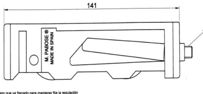
\* Espárrago que va frenado para mantener fija la regulación
