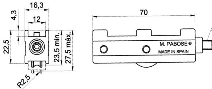
\* Espárrago que va frenado para mantener fija la regulación
