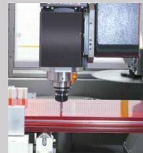
Las mordazas para el bloqueo de la pieza se deslizan sobre guías de precisión y se colocan con motorización independiente de cada mordaza, controlado por CNC
