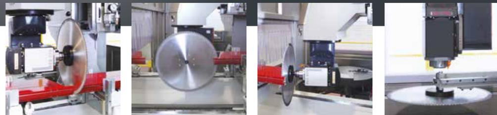
**Adequado para las operaciones de fresado, taladrado, roscado y corte en 5 caras de perfiles de aluminio y aleaciones ligeras**
