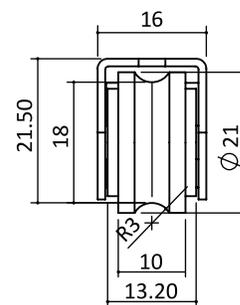
Este documento certifica el valor de la carga máxima recomendada del conjunto rodamiento, compuesto por una rueda de acetal, un casquillo de agujas y un casquillo interior tras haber superado con éxito los ensayos a los que ha sido sometido con una carga superior.
