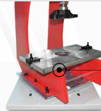
Tornillo para sujetar base giratoria
