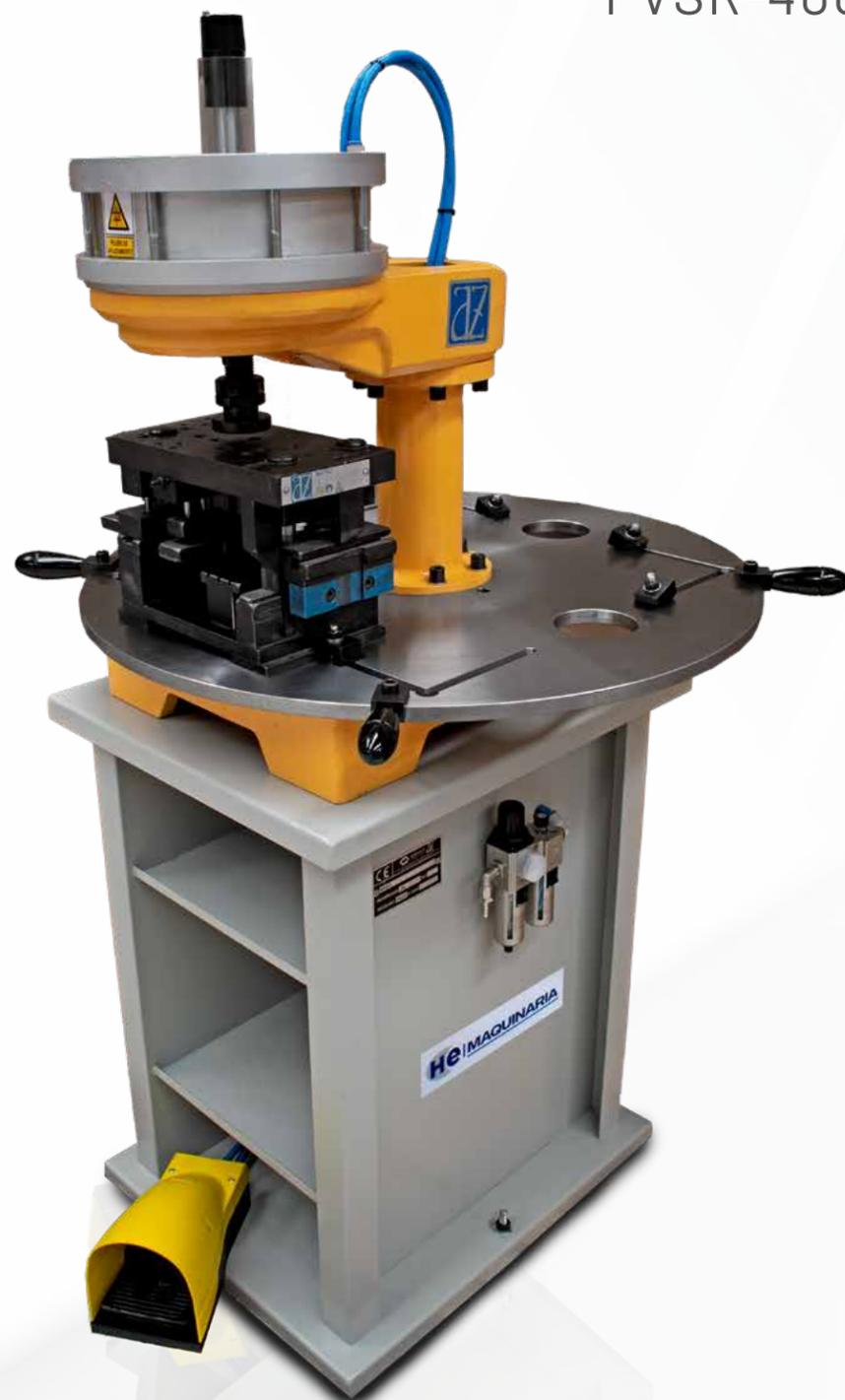
Especialmente diseñada con su alimentador para estacionar **varias matrices** y trabajar con cualquiera de ellas una vez colocadas en la mesa giratoria.
