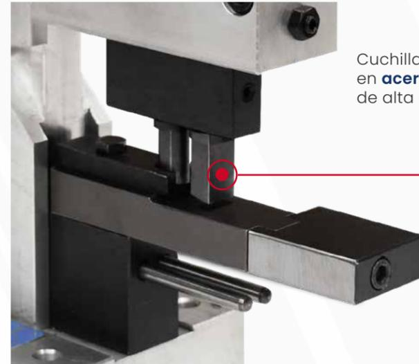
Cuchillas y ranuras en **acero templado** de alta dureza.
